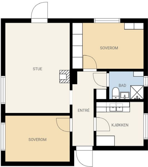
LUKKET LØSNING: Leiligheten hadde i utgangspunktet adskilt kjøkken. Kjæresteparet valgte å flytte det til rommet vegg-i-vegg med stuen – og rive den samme vegg.
